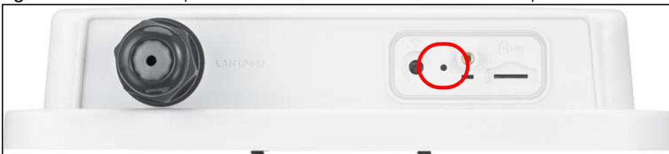
**Figure 10** Reset Button (LTE5388-S905)
